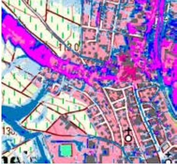
Ausschnitt aus der Präsentation Hochwassergefahren für Langenlonsheim: Rothenberger Straße als gefährdeter Bereich bei Starkregen, in rosa dargestellt.
